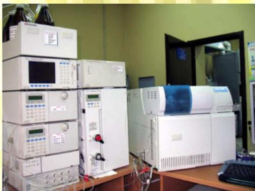
Система жидкостной хромато-масс-спектрометрии
