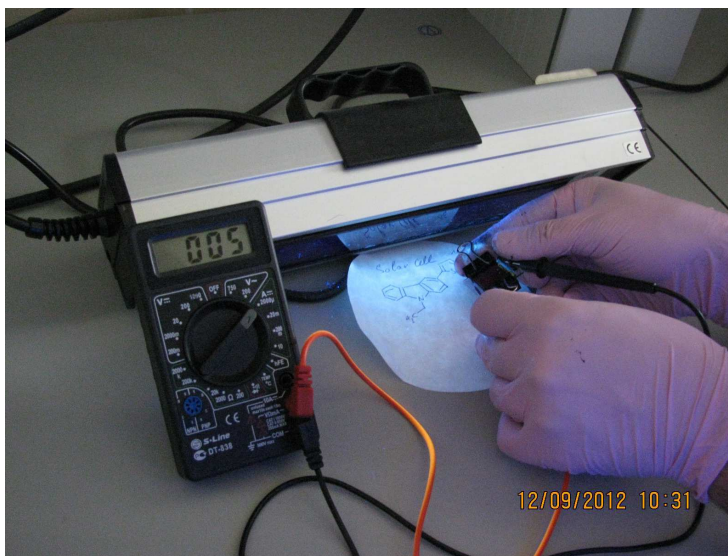
Фотография 1. Тестовая фотоэлектрохимическая ячейка
